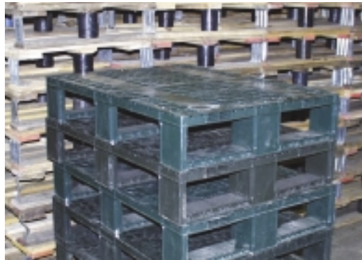
De specielt tilvirkede halvpaller kan tages fra både den korte og den lange side med en almindelig palleløfter.
