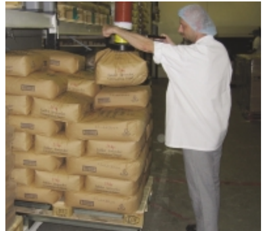
Reolerne er udstyret med palle-skuffer, så man uhindret kan bruge vaccumløfteren.
