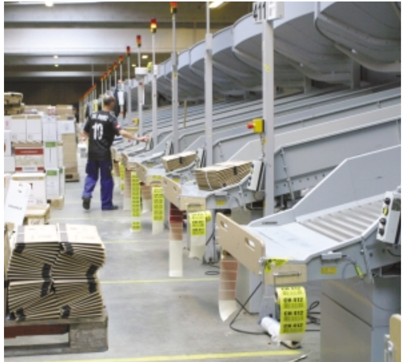
Palleteringsarbejdspladserne er meget fleksible og både sliske og paller kan justeres i højden, så optimale løftehøjder kan opnås.
