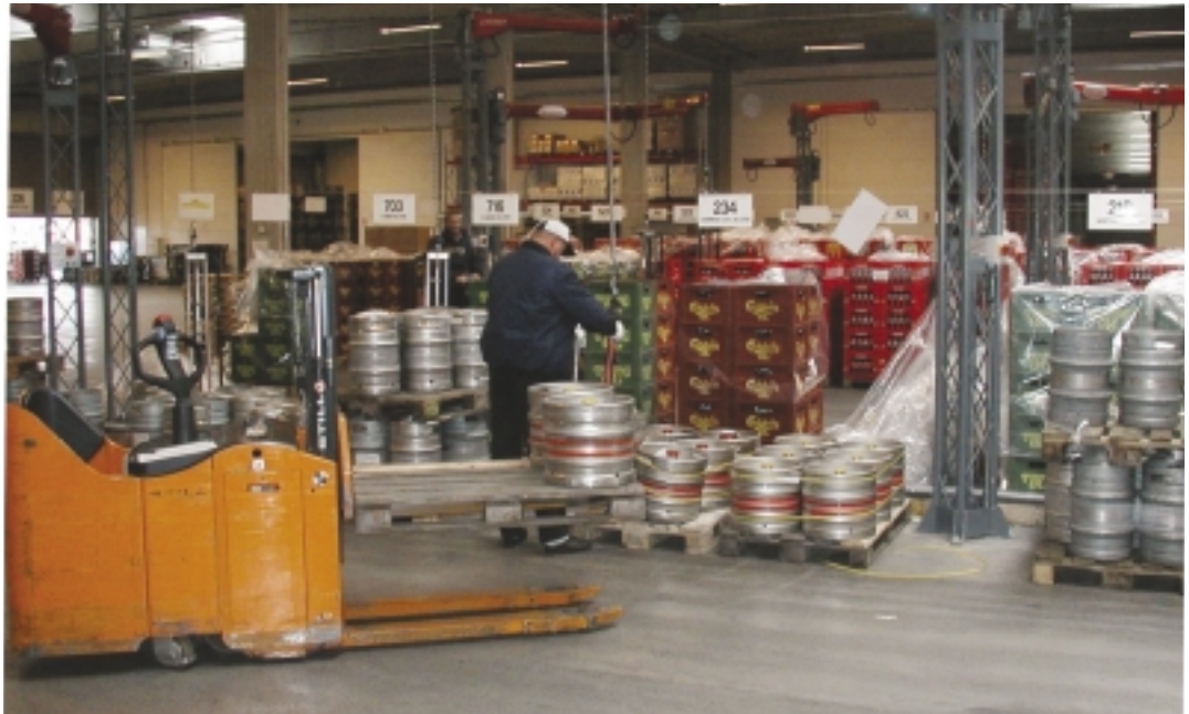
Kombinationen af kraner og højdeindstillelige ekspeditionsvogne giver gode arbejdsstillinger.
