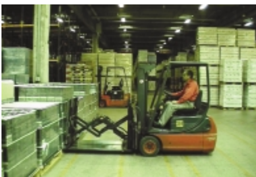
Truck med slip-sheet tønningsudstyr. Ved brug af slip-sheets undgås manuel håndtering ved tømning af containere.
