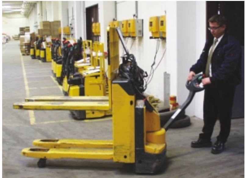
Palleløfterne på lageret kan justeres i højden, så arbejdsstillingerne forbedres.
