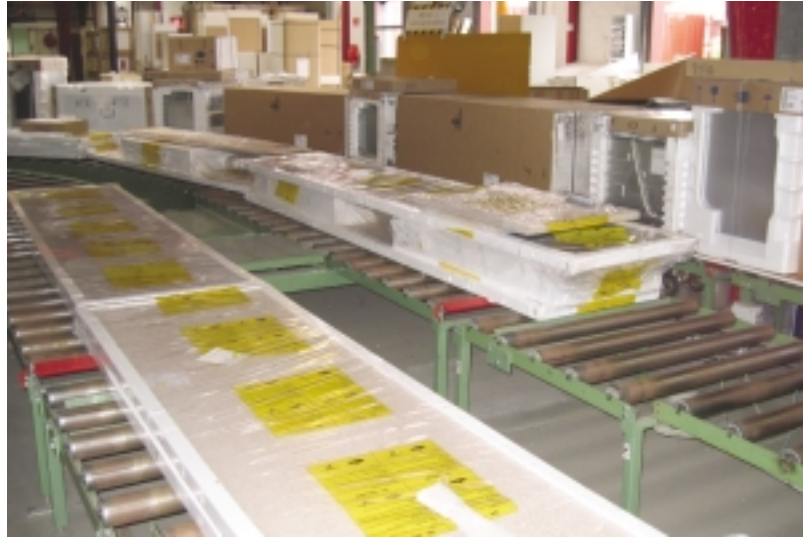
Lageret er bare den sidste del af de mange kilometer rullebaner, der går gennem hele produktionen.
