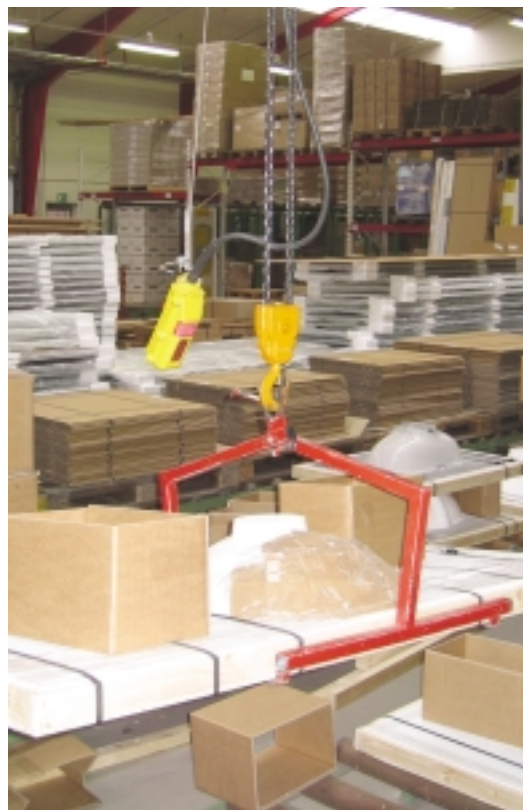
De tunge bordplader løftes med kran.
