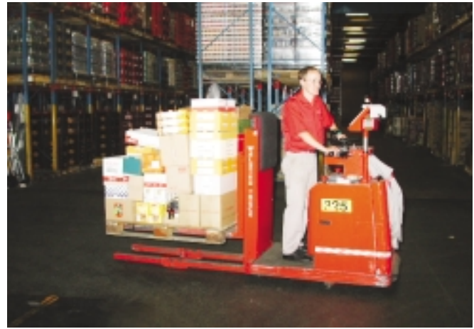
El-hest (el-stabler) med hævbare gaffler. Giver mulighed for en hensigtsmæssig arbejds højde ved ekspeditionsarbejdet.
