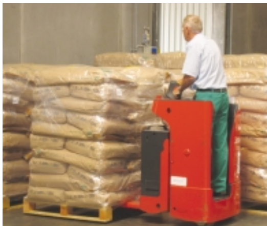
Ekspeditionsvognene på lageret blev valgt, fordi de giver en god beskyttelse af føreren og på grund af den gode affjedring.
