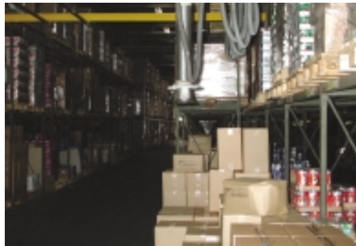
Vacumsugeren bruges til håndtering af de tungeste varenumre, som placeres i dette område.
