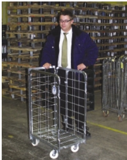
De små mælkecontainere sparer mange løft, da mælken ikke skal omlastes.
