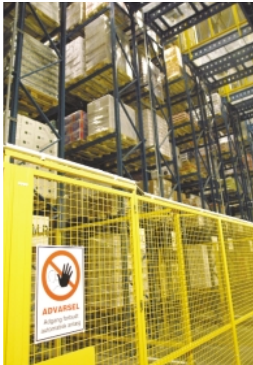
Hele det automatiske højlager er sikret i zoner og afbrydes straks, hvis lågerne åbnes.
