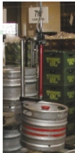
Gribe- og håndteringsværktøjet styrer kranen, så kranen følger medarbejderens bevægelser. Fustagens vægt på 37 kg er reduceret til 20 g.
