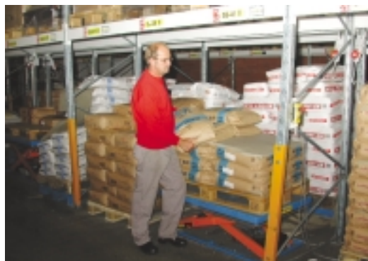
Løftebordet nedsætter belastningen, da det er muligt at løfte varen i en hensigtsmæssig arbejds højde. Ved brug af el-hest med hævbare gaffler kan varen også afsættes i en god arbejds- højde.
