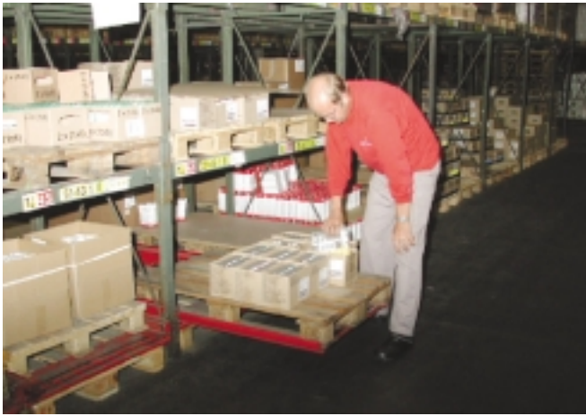
Skuffetræk bruges for at nedsætte rækkeafstanden og sikre hensigtsmæssige arbejdstillinger ved ekspedition fra pallepladser.
