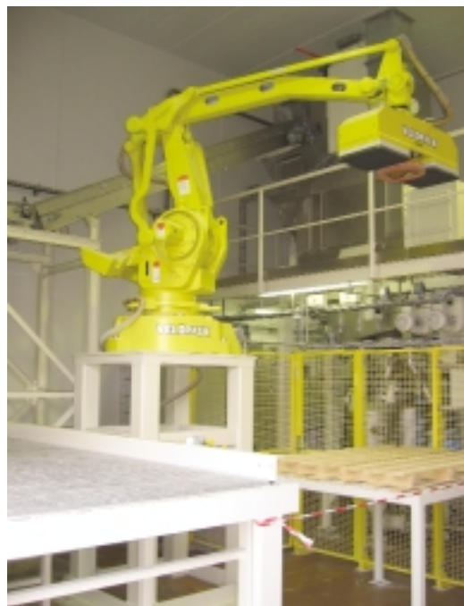
Robotter har overtaget det tunge og støvende arbejde med at depallete.
