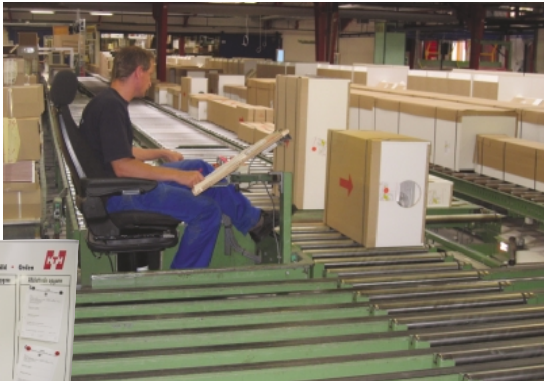
Plukkeren kører frem og tilbage mellem de forskellige rullebaner og sikrer, at det er de rigtige varer, der kommer med den rigtige bil i den rigtige rækkefølge.
