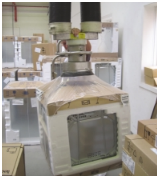
Vacuumløfteren har fjernet de mange tunge løft af hårde hvidevarer.
